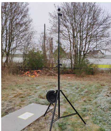
Abbildung 68: Messaufbau der Messung am 5.12.2019 zur Erfassung der Lärmsanierungsmaßnahme „Schallschutzwand“, links im Abstand 7,5 m, rechts im Abstand 18,5 m.
