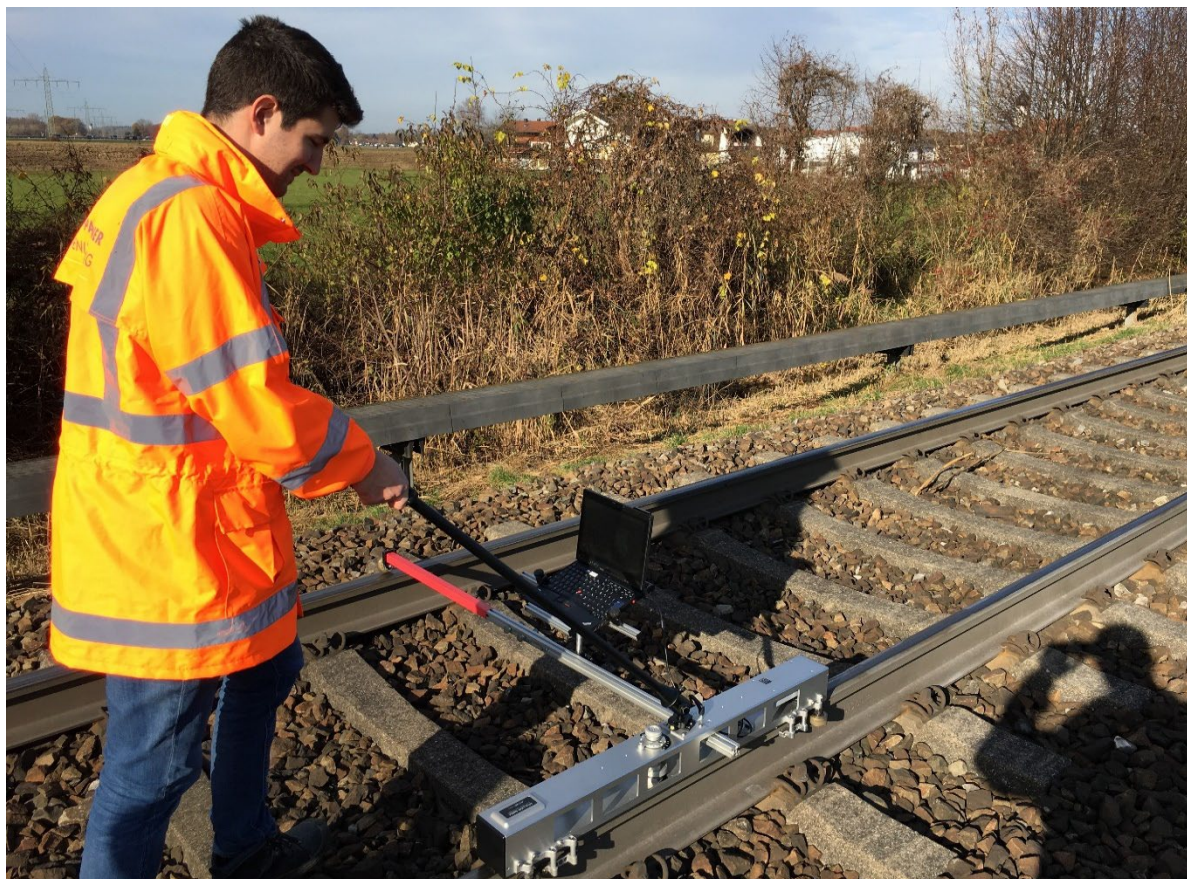
Abbildung 86: Messgerät zur Bestimmung der Schienenrauheit m | rail trolley
