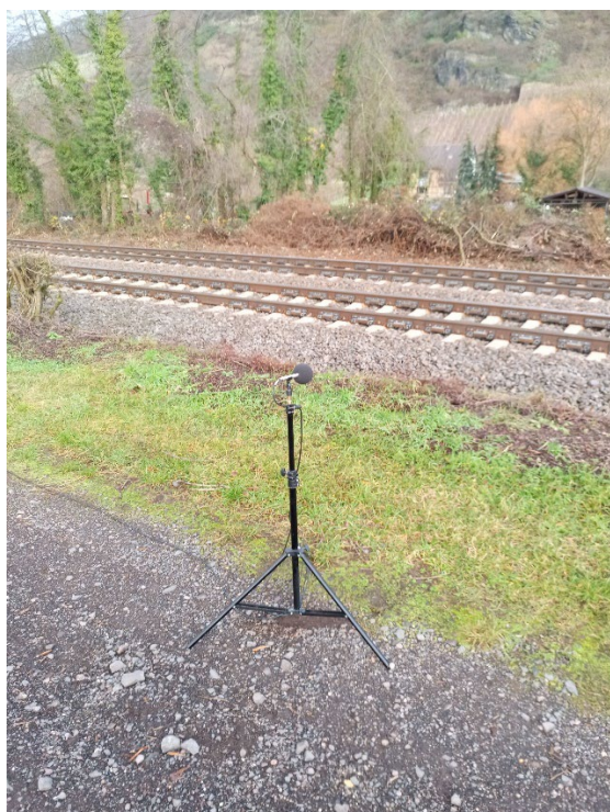
Abbildung 69: Messaufbau der Messung am 18.12.2019 (links) zur Erfassung der Lärmsanierungsmaßnahme „Schienenstegdämpfer“ (rechts)
