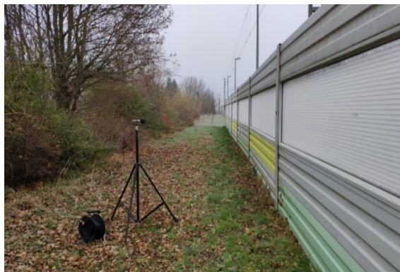
Abbildung 68: Messaufbau der Messung am 5.12.2019 zur Erfassung der Lärmsanierungsmaßnahme „Schallschutzwand“, links im Abstand 7,5 m, rechts im Abstand 18,5 m.
