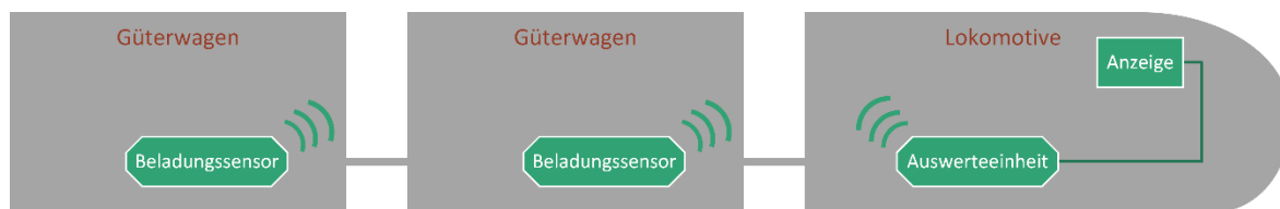
Abbildung 6: Schematische Darstellung des Zugintegritätssystem (ZIS)
