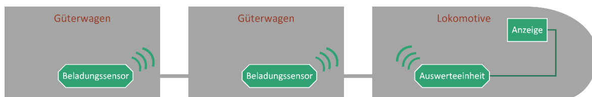
Abbildung A.26: Schematische Darstellung des ZIS
