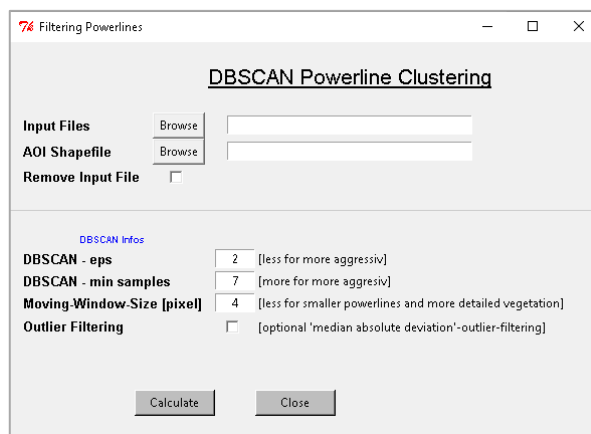
Abbildung 1: Grafische Oberfläche zur Filterung von Oberleitungen
