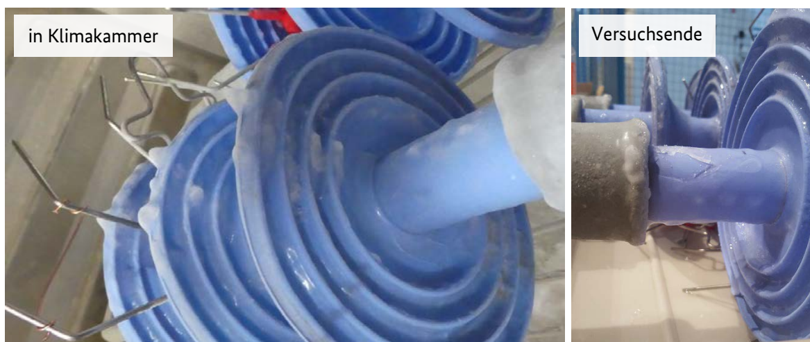
Abbildung 20: Vereiste Isolatoren in der Klimakammer (links) und nach Beendigung der Messungen (rechts)
