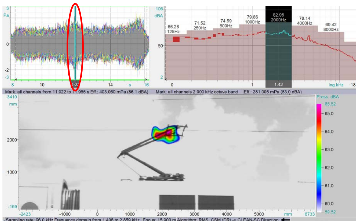
Abbildung 9: Akustisches Foto des Stromabnehmers eines ICEs (Messung 1) aus dem Spektrum. Oben links: Zeitsignal mit ausgewähltem Integrationsbereich (hervorgehoben durch das rote Oval); oben rechts: Spektrum mit ausgewähltem Frequenzbereich für das Beamforming; unten: Akustisches Foto
