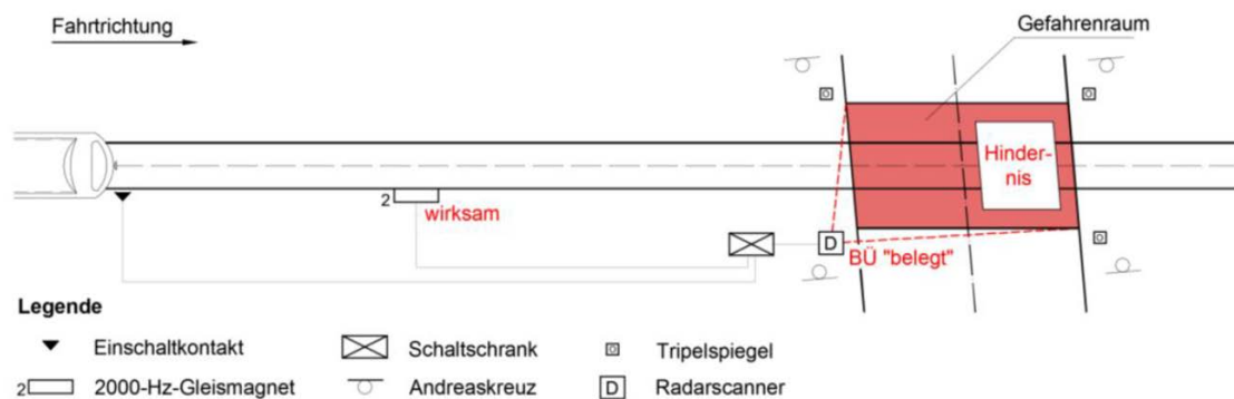
Abbildung 55: Systemlösung für nichttechnisch gesicherte BÜ [56]
