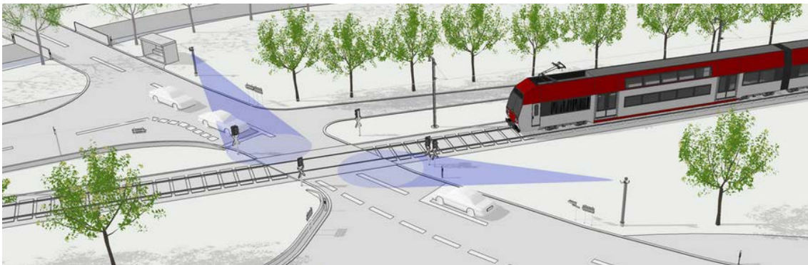
Abbildung 28: Prinzipskizze Rotlichtüberwachung am BÜ [21]
