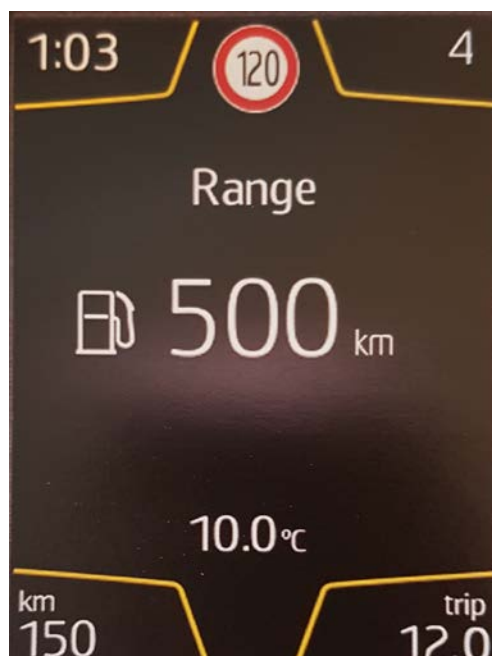
Abbildung 60: Verkehrszeichenerkennung im Armaturenbrett [68]
