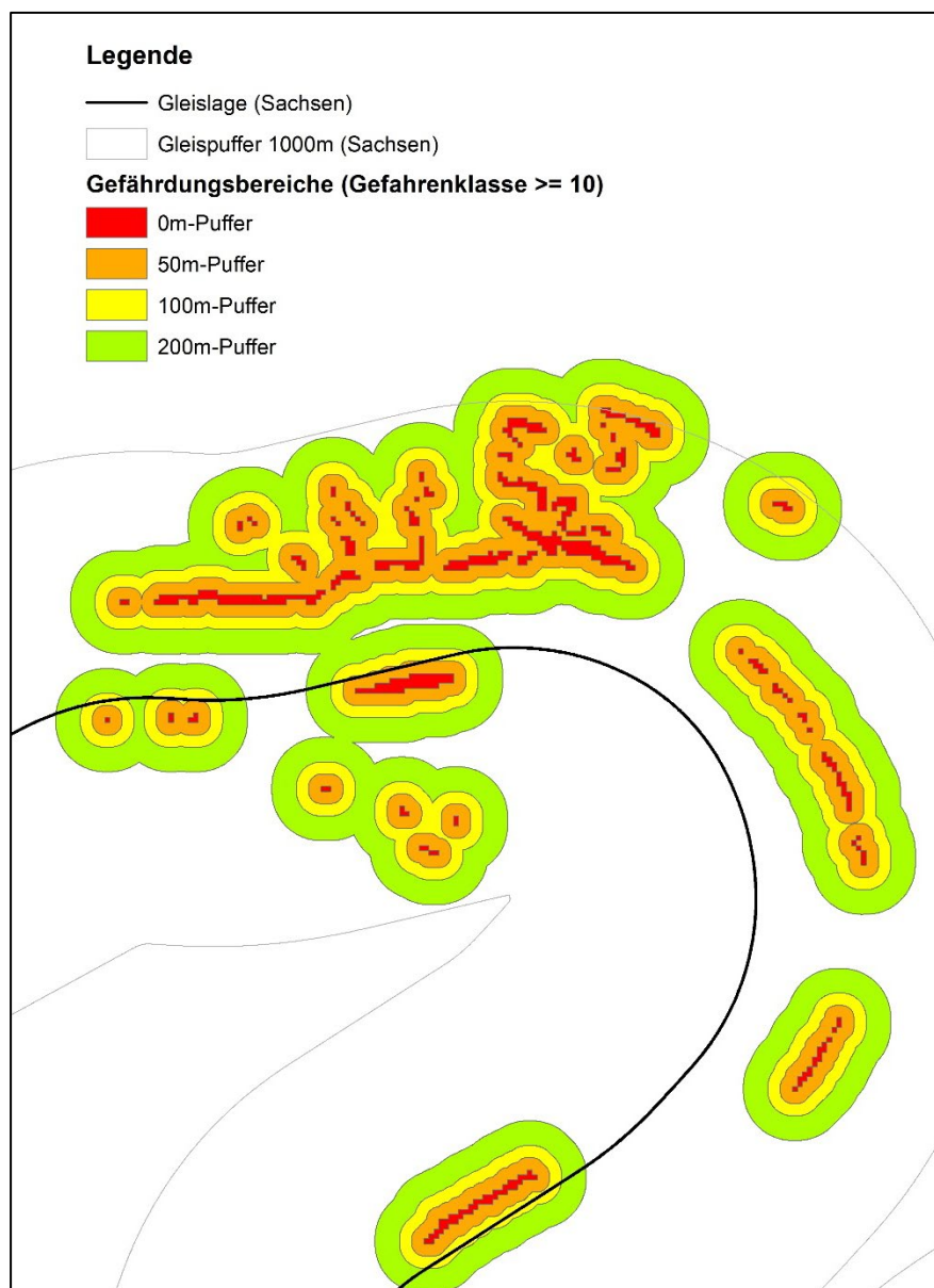
Abbildung 60: Erstellte Gefährdungsbereiche in 0 m, 50 m, 100 m und 200 m Abstand (Puffer) um die berechneten Bereiche mit einer Gefahrenklasse größer bzw. gleich 10 entsprechend Ansatz 1
