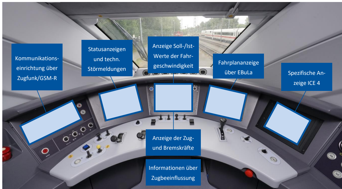
Abbildung 24: Führerraumanzeigen und Informationen im Tfz am Beispiel des ICE 4 (BR 412) (Verändert nach Deutsche Bahn AG / Volker Emersleben)
