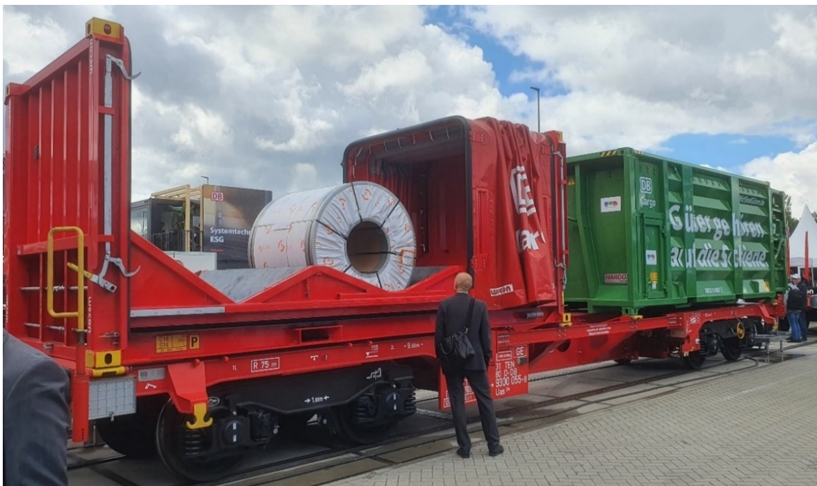
Abbildung 17: Der modulare Güterwagen m 2 , entwickelt durch die DB Cargo AG, gefördert durch das vom DZSF betreute Bundesprogramm Z-SGV. Der neue Wagen wurde auf der Messe InnoTrans vorgestellt. Foto: DZSF/Menzel.
