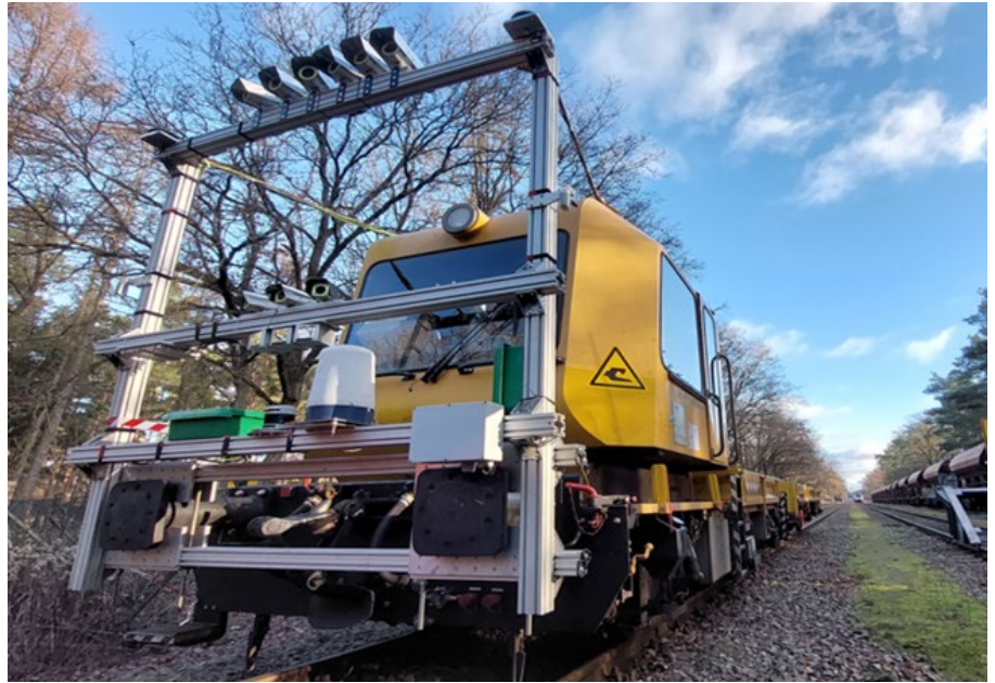
2: Sensorkonfiguration am Datenerhebungsfahrzeug
