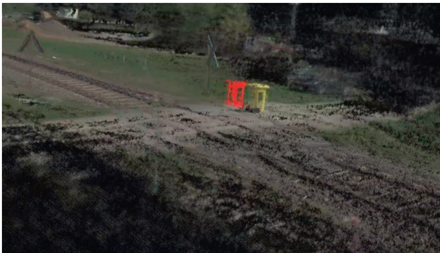
Abb. 7: Vergleich eines Testobjekt mit Positionsänderung in 3D-Punktwolken
